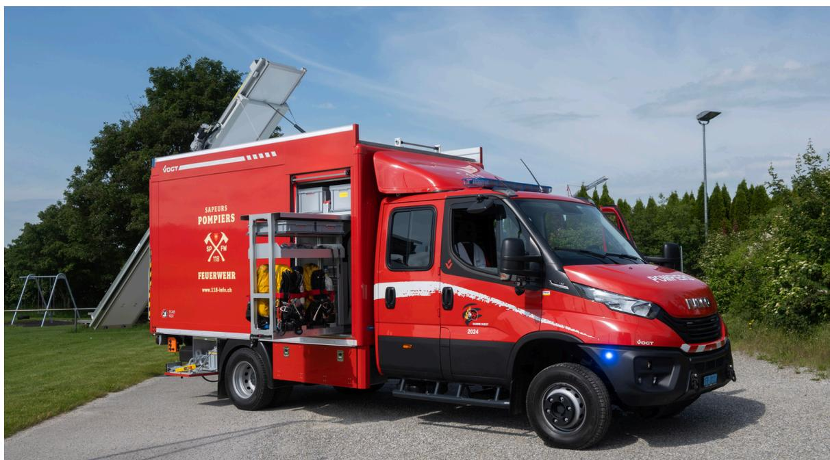
Le Bataillon Sarine accueille un nouveau véhicule d'intervention de la marque Iveco. Avec une cylindrée de 2998 cm<sup>3</sup>, il pèse 5230 kg à vide et peut atteindre un poids total de 7000 kg. Ce véhicule est équipé d'une échelle avec appuis et peut transporter 4 modules et 6 personnes (2 à l'avant, 4 à l'arrière). À terme, toutes les compagnies seront équipées de ce type de véhicule pour améliorer leurs capacités d'intervention.
